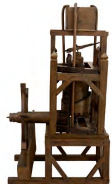
Modell eines dreifachen Pumpwerks zum Heben von Wasser, Casper Walter, Augsburg vor 1751. Quelle: Kunstsammlungen und Museen Augsburg, Maximilianmuseum, Inv. Nr. 9606. Foto: Lenz Mayer
